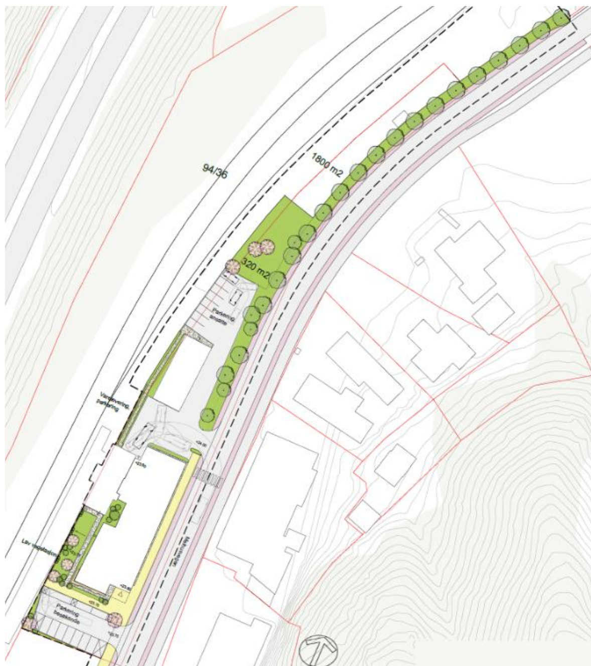
Figur 3: Planskisse per 27.04.2021, utformet av Pir II AS. Tomten reguleres for kombinert forretning/kontor/tjenesteyting. Adkomst for besøkende i sør, mens varelevering og ansatte benytter avkjørsel i nord.
